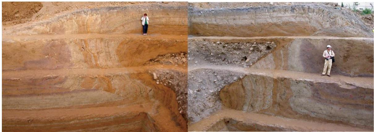
圖 1.5 竹山槽溝南北兩牆剖面圖，左圖為北牆，右圖為南牆。從圖中可清楚看見層序排列、褶皺以及斷層截切關係。北牆能看見槽溝褶皺的向斜軸處被截切，南牆能看見褶皺的背斜軸處被截切，並且切穿至地表 (Huang et al., 2016)
